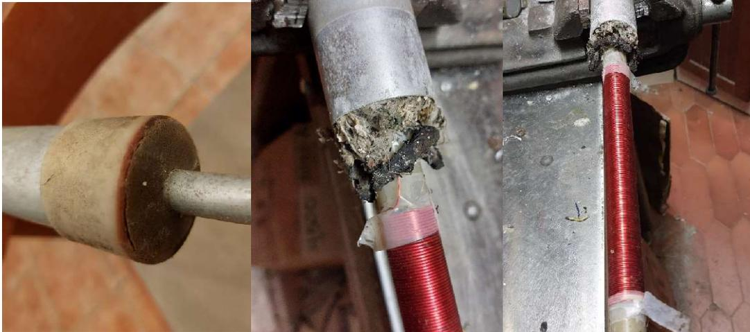
Questa trappola ha anche subito qualche problema a causa di QRO negli ultimi 10 giri terminali della bobina. Li ho sostituiti con del filo smaltato di identico diametro e la giunzione isolata con nastro di teflon:
