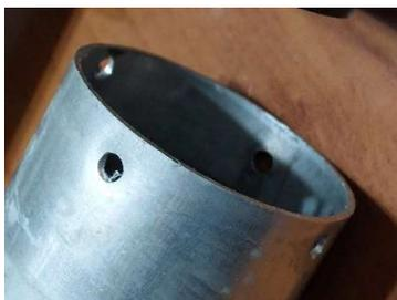
Fatti i quattro fori, sfilare con forza tutto l'interno della trappola. Il risultato sarà questo per la trappola dei 10 metri (ho già tolto l'infinità di insetti morti all'interno):
