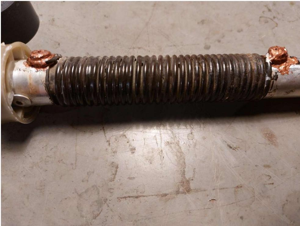
Le trappole dei 10 e 15 metri sono avvolte con filo di alluminio non smaltato ma isolato con resina epossidica nera. Invece la trappola dei 20 metri è realizzata con filo di rame da 2mm smaltato:
