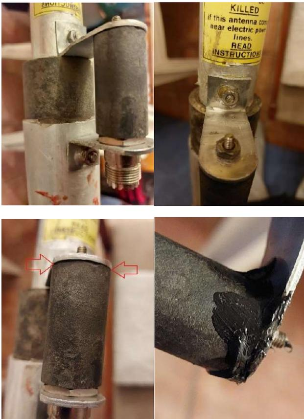
Per smontare le trappole, il sistema è identico a quelle HyGain e cioè, va sfilata la cuffia di protezione dalla pioggia e in corrispondenza dei quattro punzoni, con una punta da trapano da 3mm, effettuare un foro cercando di non bucare troppo l'isolatore sottostante:
